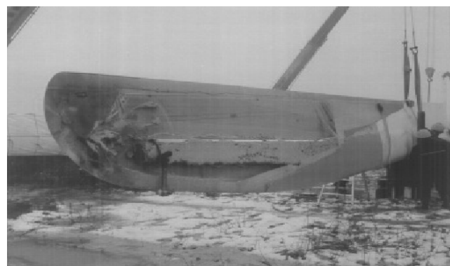
図1 落雷により破損したブレード
