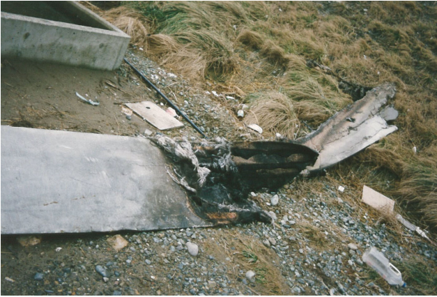
図3 焼損したブレード部
